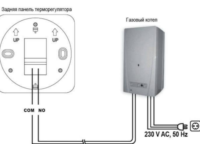
Если у вас старый котел или другое устройство (например, насос), который не приспособлен для подключения комнатного термостата, подключите клеммы **NO** и **COM** термостата в качестве переключателя цепи подключения к сети устройства, которым вы хотите управлять.
