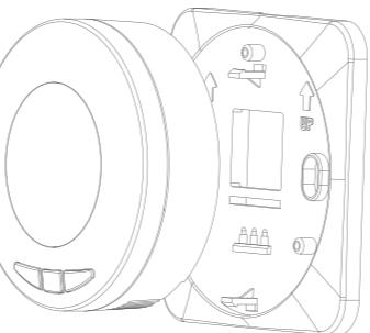
2. Прикрепите заднюю часть прибора к стене с помощью прилагаемых крепежных винтов. Убедитесь, что стрелки с внутренней стороны направлены вверх.
