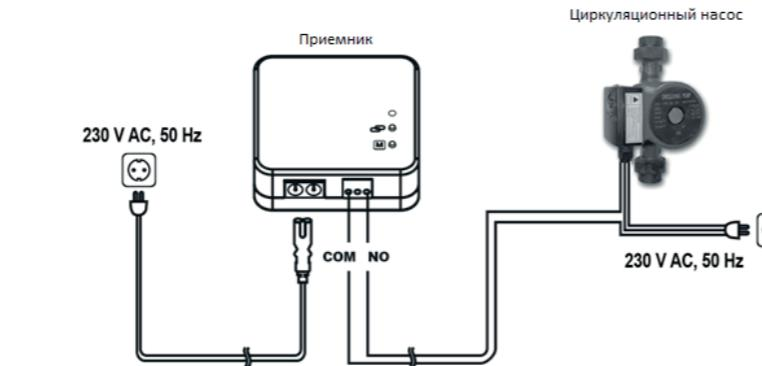
Напряжение в точках подключения **NO** и **COM** зависит только от управляемой системы, поэтому размер используемого провода определяется типом управляемого устройства. Длина кабеля не имеет значения, вы можете установить приемник рядом или вдали от котла, но не устанавливайте его непосредственно вблизи или под ним.
