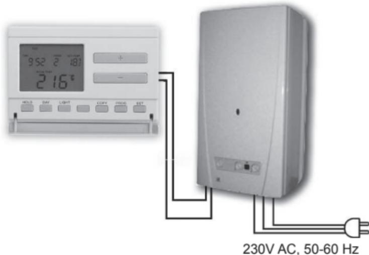
Прибор может быть запрограммирован в соответствии с индивидуальными запросами, чтобы система отопления (охлаждения) позволяла нагревать (охлаждать) квартиру или офис до произвольно заданной температуры. Тем самым достигая максимальной степени комфорта и способствовать снижению расходов электроэнергии. Ежедневную независимую температурную программу можно задать отдельно на каждый день недели.
